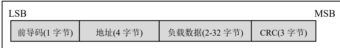
图 6.1-4 BLE-蓝牙数据包格式
